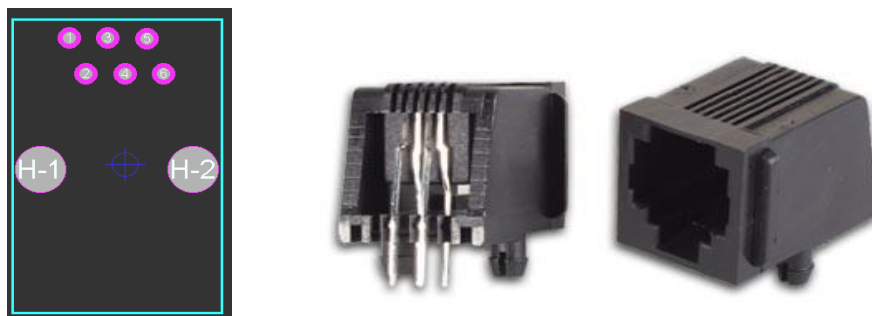
Un exemple de création de composant : le connecteur RJ11
